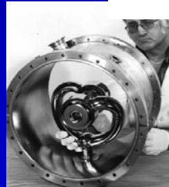
Résonateurs split-ring (ATLAS, Argonne) 97 et 145 MHz - \beta = 0,06 à 0,16
