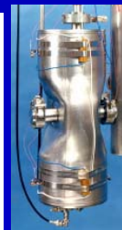
Résonateur demi-onde (Argonne) 355 MHz - \beta = 0,12
