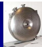
Cavité ré-entrante (Legnaro) 352 MHz - \beta \geq 0,1
