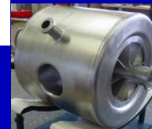
Cavités spoke (CNRS Orsay) 352 MHz - \beta = 0,15 et 0,35
