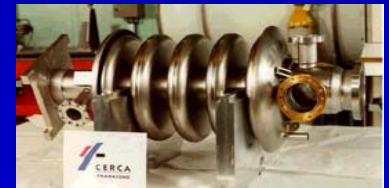
Cavité APT (Los Alamos) 700 MHz - \beta = 0,64
