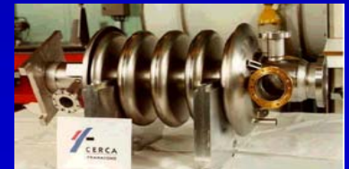
Cavité APT (Los Alamos) 700 MHz - \beta = 0,64
