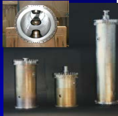
Résonateurs quart d'onde (ALPI, Legnaro) 80 à 352 MHz - \beta = 0,047 à 0,25
